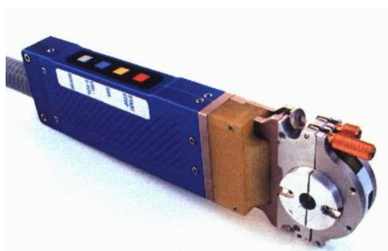
Модификация с широкой зажимной кассетой и сменными вставками зажимного патрона.
